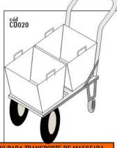
Possibilita o transporte adequado das masseiras metálicas, inclusive com posicionamento destas abaixo das argamasseiras e/ou betoneiras, diminuindo desta forma as indesejáveis paradas dos pedreiros por falta de material.
